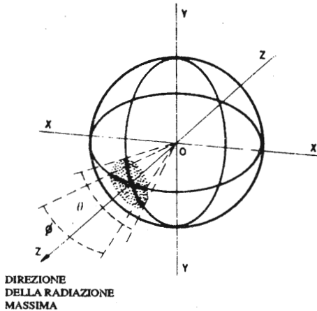
Fig. 4.- Un irradiatore isotropico posto nel punto O illuminerà tutta la sfera. Una antenna direzionale posta nello stesso punto concentra tutta la potenza nella zona ombreggiata, essendo il guadagno di potenza pari alla superficie totale dell'antenna, divisa per l'area ombreggiata.
